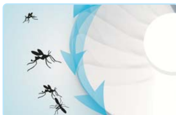
מאוורר עוצמתי שואב את המעופפים הנמשכים למכשיר ומעבירים במשפך חד-כיווני לתא האיסוף
